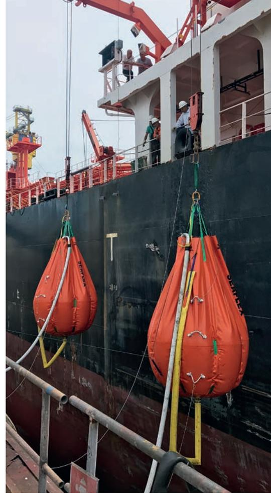
**Il principio** è quello di fornire dei palloni di pesi molto ridotti, che riempiti con acqua raggiungono portate molto elevate, senza limiti.
